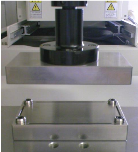
(a) 圧入用の上治具と下治具をプレス装置にセットする。
