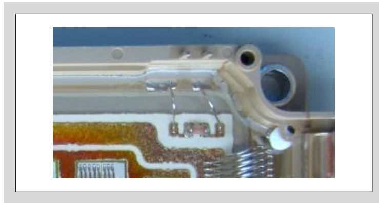
図1. NTCサーミスタを内蔵したIGBTモジュールの内部構造の一例
