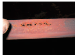
⑦ タービン軸受廻りドレン 配管(復水器内貫通)
