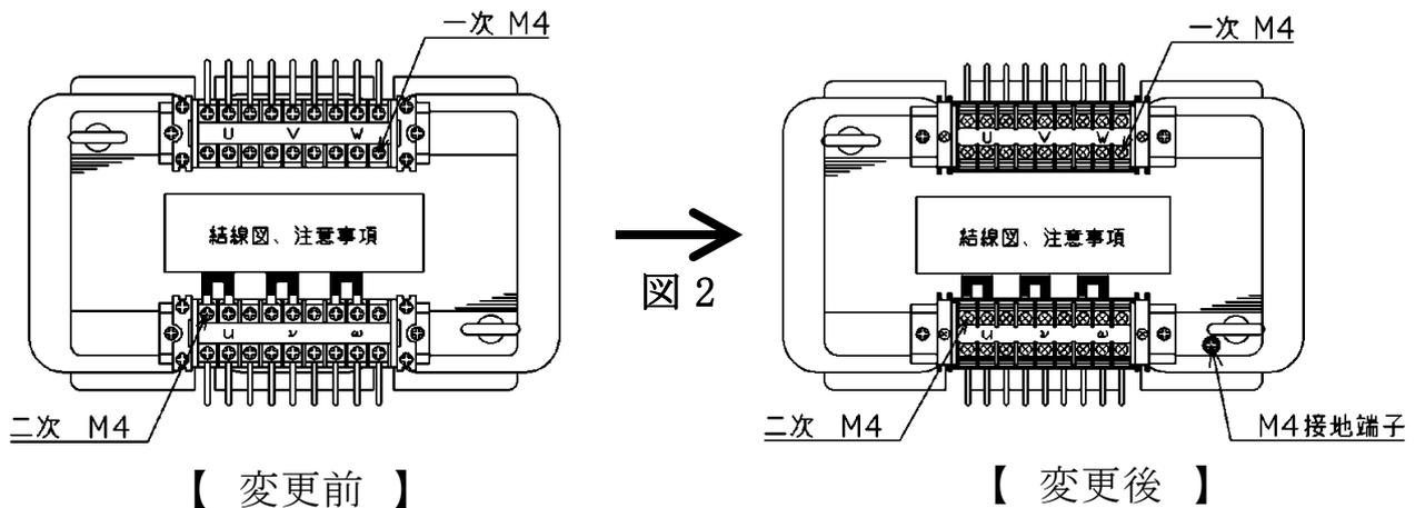
**低圧操作用変圧器 端子変更比較図**
