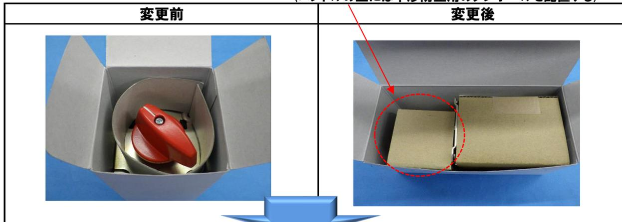
2) 干渉防止用ダンボールの上に付属品を配置するように変更する。
