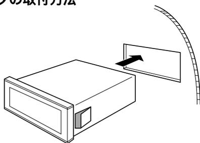
本体を前面より押し込むだけで取付けができるスナップ取付方式です。
