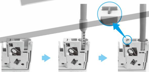
電線の差し込みが確実に行われるとオレンジ色の表示で突出確認できます。(棒端子使用時)
