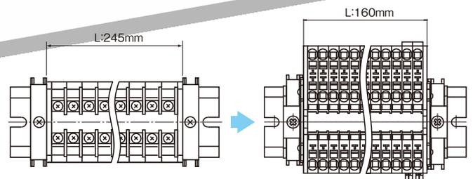
(弊社ねじ式端子台 LT2E-020 形とねじなし式端子台 LT2V-022N 形 30 極での比較)
