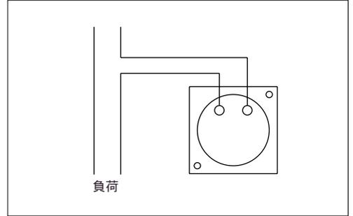
図2 交流電流計(CT接続)
