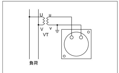
図3 600V直接接続交流電圧計
