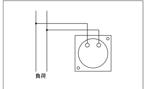
図2 交流電圧計(VT接続)
