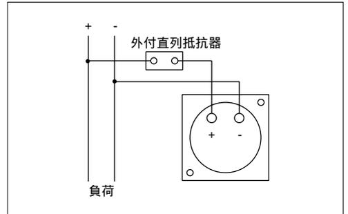
図3 直流電圧計(3端子直列抵抗器外付)
