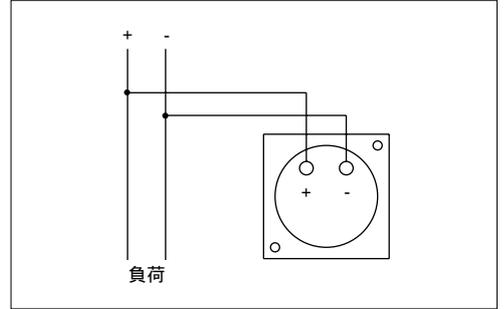
図2 直流電圧計(2端子直列抵抗器外付)
